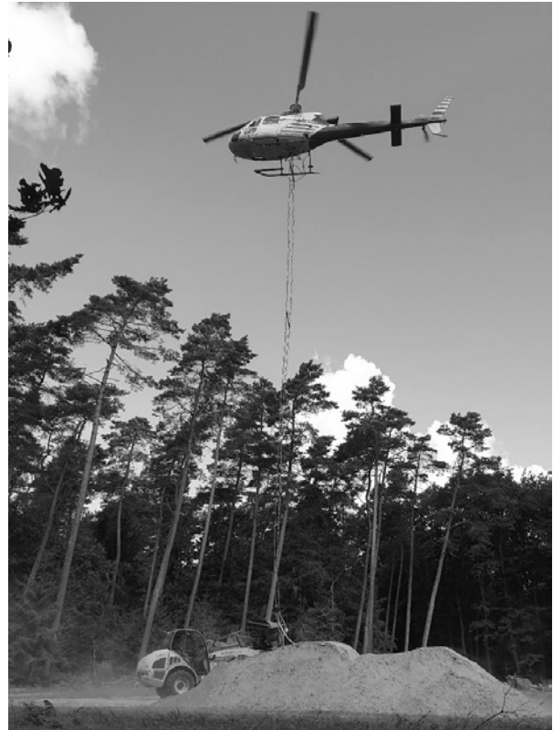
Am Befüllplatz wird der Helikopter mit Kalkmaterial beladen. Von dort aus bringt er Dolomit beziehungsweise Dolomit-Holzasche-Gemische auf die Waldflächen aus, um versauerte Waldböden zu stabilisieren und die Nährstoffversorgung der Wälder zu verbessern (Archivbild aus dem Stadtwald Eberbach aus dem Jahr 2023). (Quelle: Landratsamt Rhein-Neckar-Kreis)
